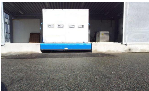
Løftebord med indbygget rullebaner til og fra løftebordet samt i løftebordet. Til transport af flycontainere.
