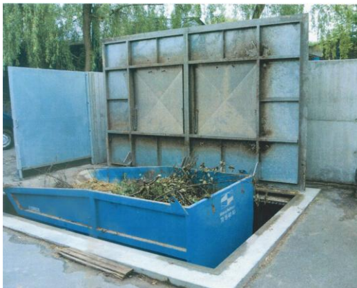
Løftebord med hydraulisk låg til møddingecontainer.
